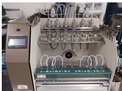
PCB分析前処理装置 PCB分析前にサンプルを精製
