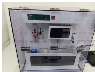
PCBフロー式イムノセンサ DXS-610 PCB測定に使用
