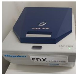
エネルギー分散型蛍光 X 線分析装置 含まれる元素の種類や割合を分析
