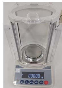
分析用電子天秤 蛍光X線分析やPCB測定 サンプルの前処理などで使用
