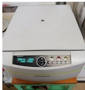
卓上遠心機 遠心による水分値測定、PCB測定 サンプルの前処理などで使用
