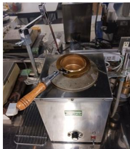
クリーブランド開放式引火点測定機 サンプルを加熱し引火時の 最低温度を測定
