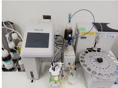
カールフィッシャー水分測定装置 遠心法より厳密に水分量を測定
