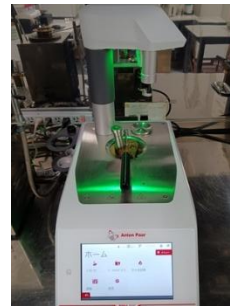
ペンスキーマルテンス密閉式自動引火点試験 サンプルを密閉して加熱し 引火時の最低温度を測定
